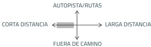
Firestone T831 es un neumático radial diseñado para uso en ejes motrices de camiones y autobuses, en rutas mixtas (pavimento y tierra), con velocidad moderada.
